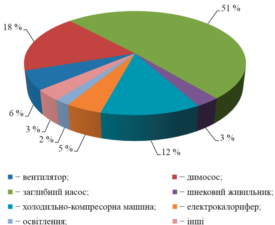
Рисунок 1.6 - Структура річного споживання електричної енергії обладнанням цеху
