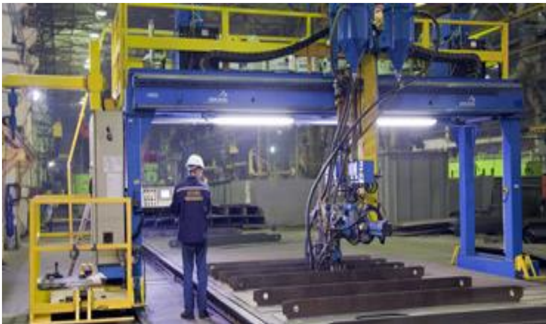
Рисунок 1.3 – Портальна зварювальна установка
