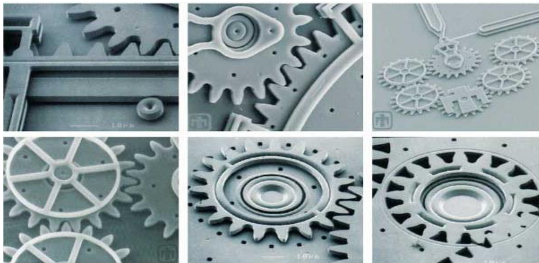
Рисунок 4.6 - Конструкції зубчатих елементів гребінчастих мікродвигунів MEMS
