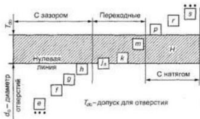
Рис. 3.2. Схема розташування поля допусків
