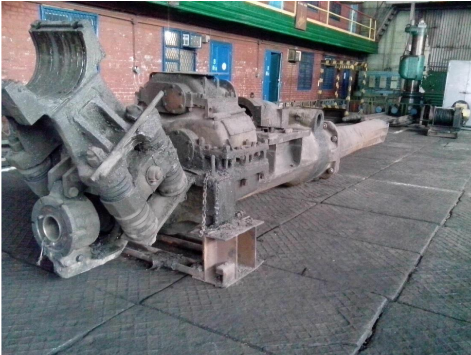
Рис. 1.10 Механізм обертання хобота мульдозавалювальної машини
