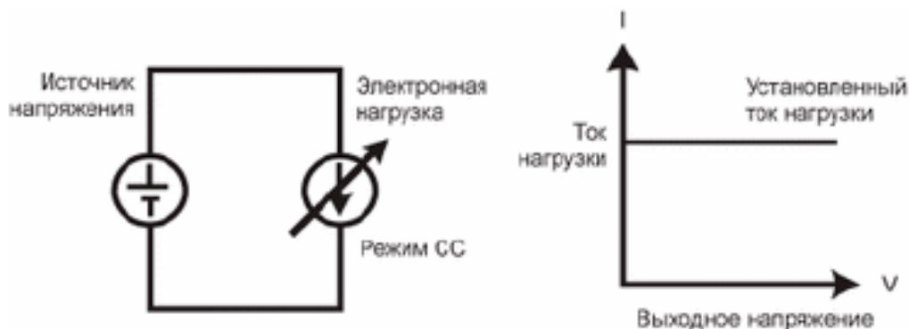
Рисунок 1.5 - Схема заміщення і графік залежності напруга-струм
