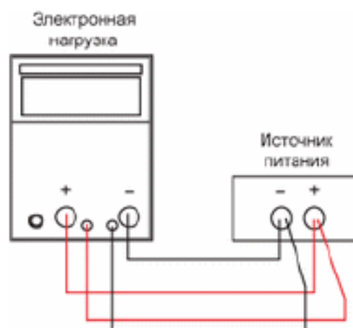
Рисунок 1.7 - Чотирьох схема підключення
