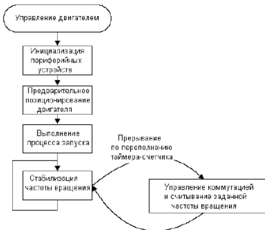
Рисунок 1.14 - Блок-схема програми управління двофазним БКЕПТ
