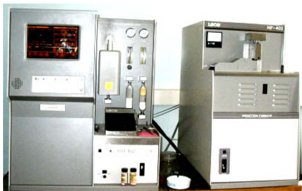
Рисунок 2 – Анализатор фирмы «LECO» RH-402, предназначенный для экспресс-анализа содержания водорода в черных, цветных металлах, сталях и сплавах и других неорганических материалах
