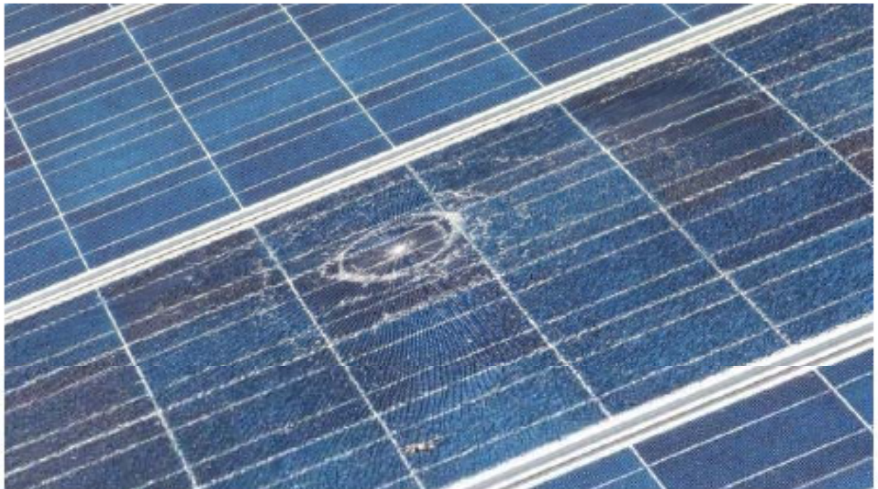
Рисунок 3.3 – Ураження блискавкою сонячної батареї
