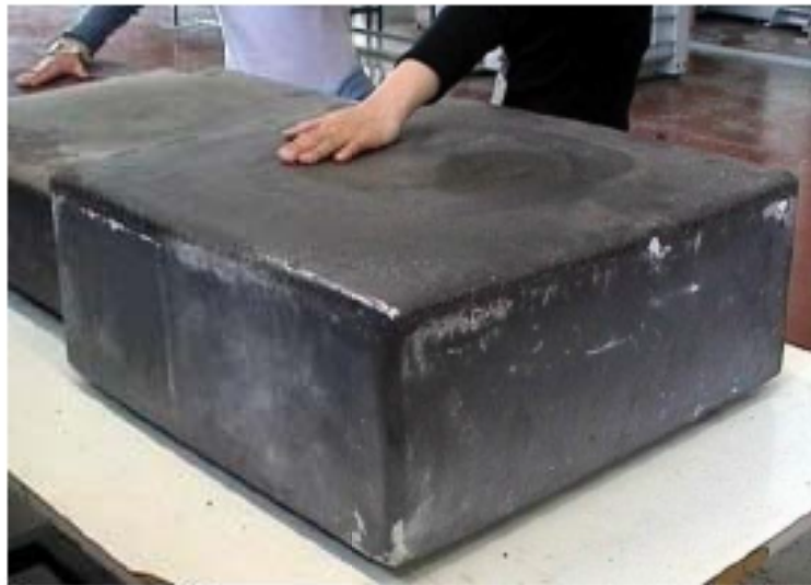
Рисунок 2.9 — Вирощений зливok мультікристалічного кремнію
