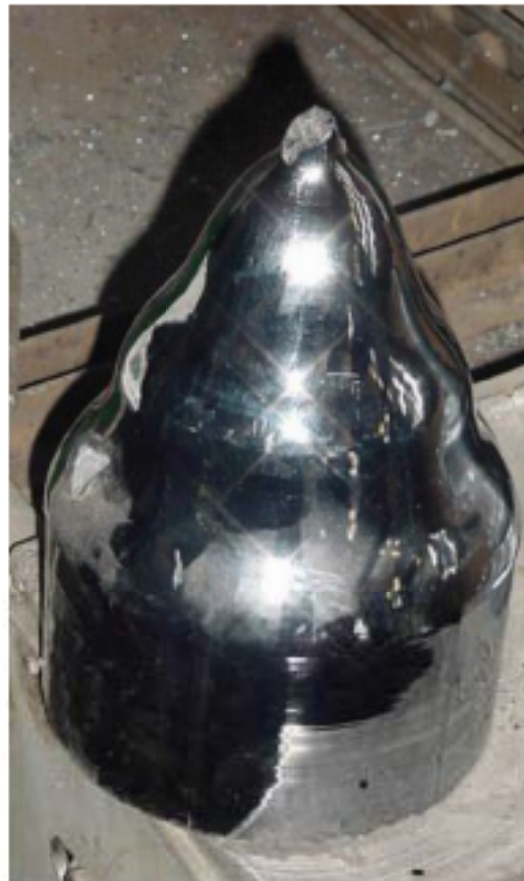
Рисунок 2.6 — Зливкок, що вирощено за методом Чохральського
