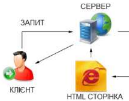
Рисунок 3.1 Принцип роботи статичного сервера
