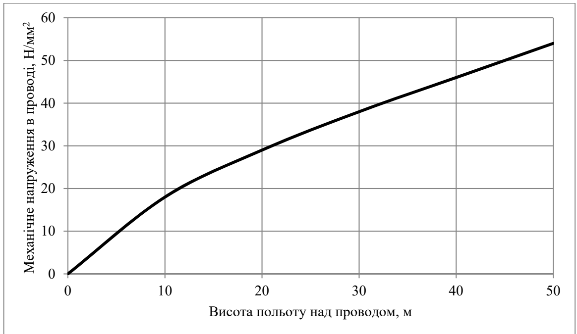
Рисунок 3.2 – Механічні напруги, створювані падінням ДПЛА на провід ПЛ
