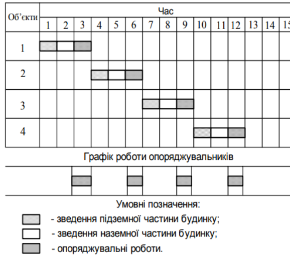
Рисунок 1.1 – Графік будівництва об'єктів при послідовному методі роботи бригад
