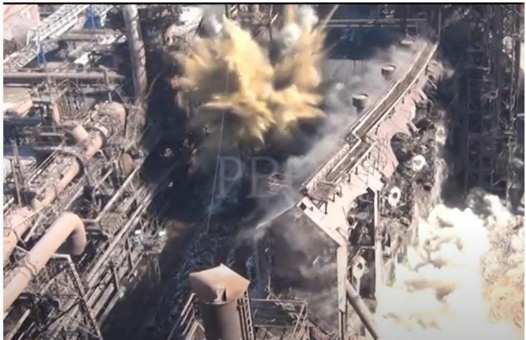
Рисунок 2.2 – Вибух приміщення повітрянагрівачів і труби на тягу, доменна піч №3 НТМК Н. Тагіл 2012.04.08
