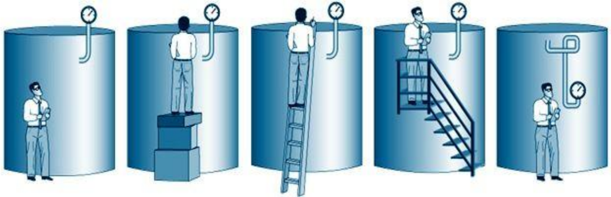
Рисунок 3.1 – Варіанти розташування приладу, що показує
