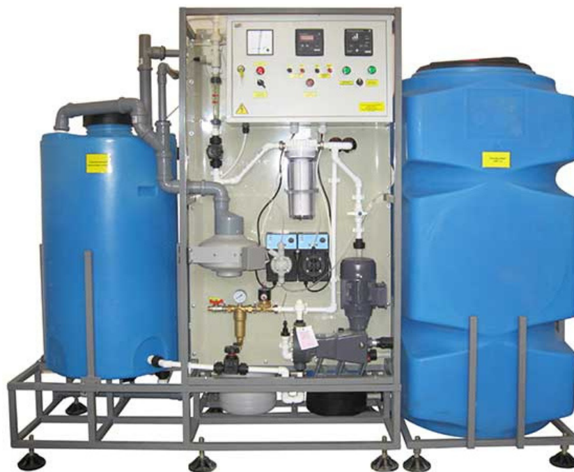
Рисунок 1.2 - Електролізна установка UE ГПХН 700С
