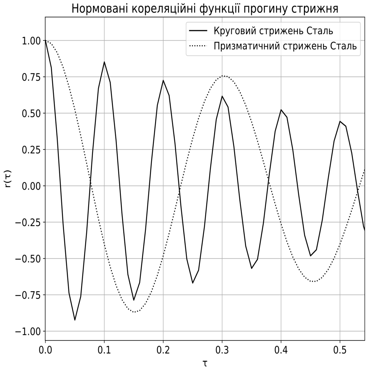
Рисунок 3.1 – Нормовані кореляційні функції прогину стрижня від параметра
