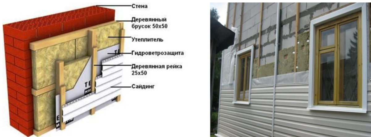
Рисунок 1.9 - Система зовнішнього утеплення з вентиляльованим проміжком
