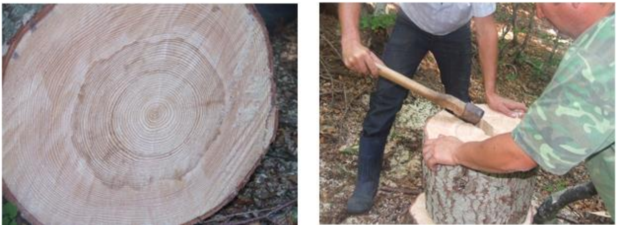
Рисунок 1.4 - Отримання гонту при подовжньому обробленні деревини
