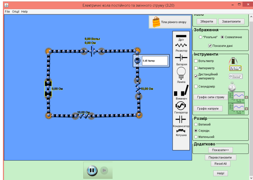
Рисунок 3.4 – Вимірювання сили струму між джерелом струму і першим резистором
