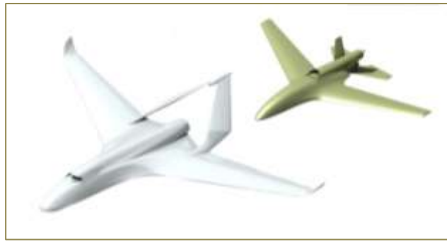
Рисунок Ж.14 – Турецький турбореактивний безпілотний літальний апарат-випробувач «Goksuungur» із турбореактивним двигуном AI-25TLT виробництва ДП «Івченко-Прогрес» [14]
