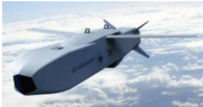
Рисунок Ж.15 – Турецька крилата ракета із двигуном AI-35 виробництва ДП «Івченко-Прогрес» [17]
