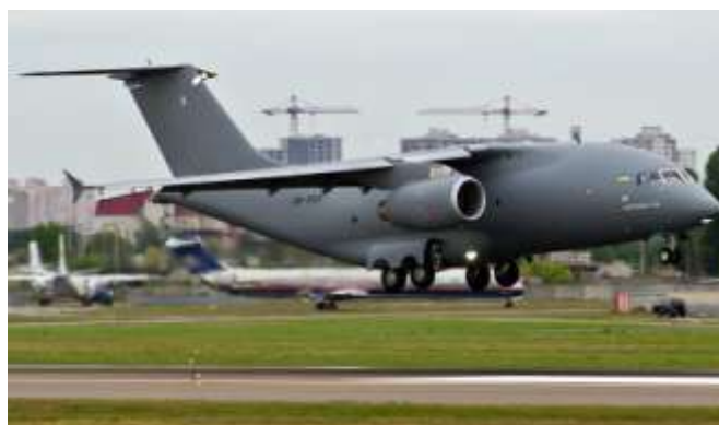
Рисунок Ж.11 – Літак Ан-178, на якому може використовуватись турбореактивний двоконтурний двигун AI-28 виробництва ДП «Івченко-Прогрес» [10]
