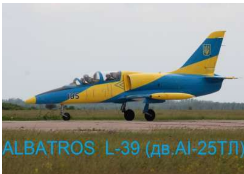
Рисунок Ж.16 – Літак L-39 із двигуном AI-25TLT виробництва ДП «Івченко-Прогрес» [15]
