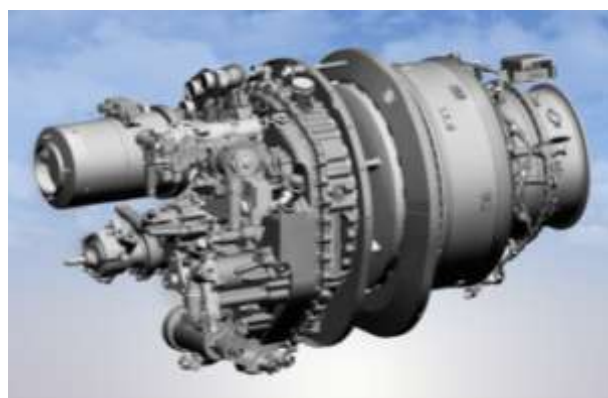
Рисунок Ж.8 – Турбовальний двигун AI-450-2 [10]
