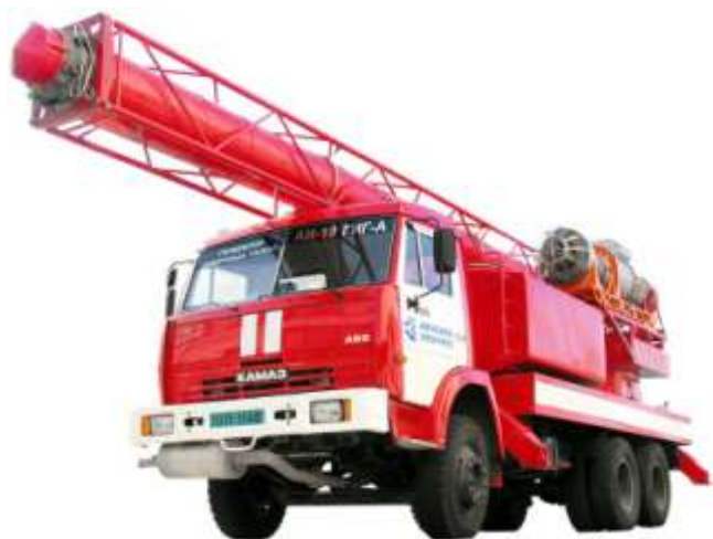
Рисунок Ж.5 – Автомобільна установка AI-19ГІГ-А [10]
