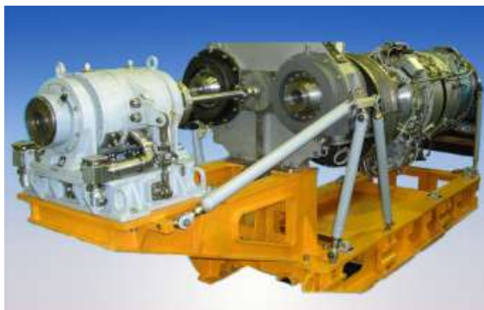
Рисунок Ж.6 – Газоперекачуючий агрегат AI-45 ГПА-Ц-0,7/45-5 [10]
