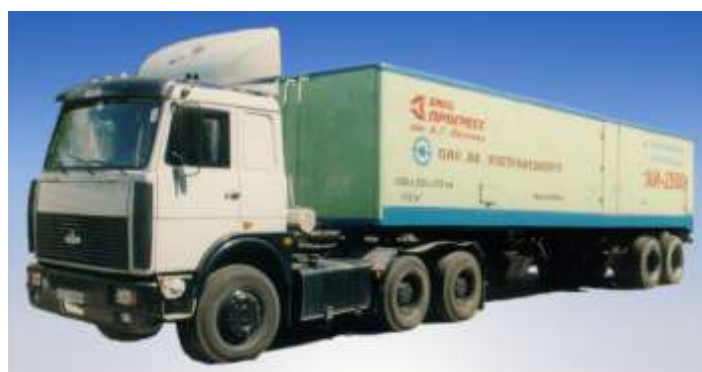
Рисунок Ж.2 – Газотурбінна електростанція АІ-2500 (ГТЕ) [10]
