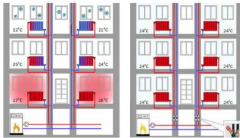
Рисунок 2.5 – Опалювальна система до та після балансування
