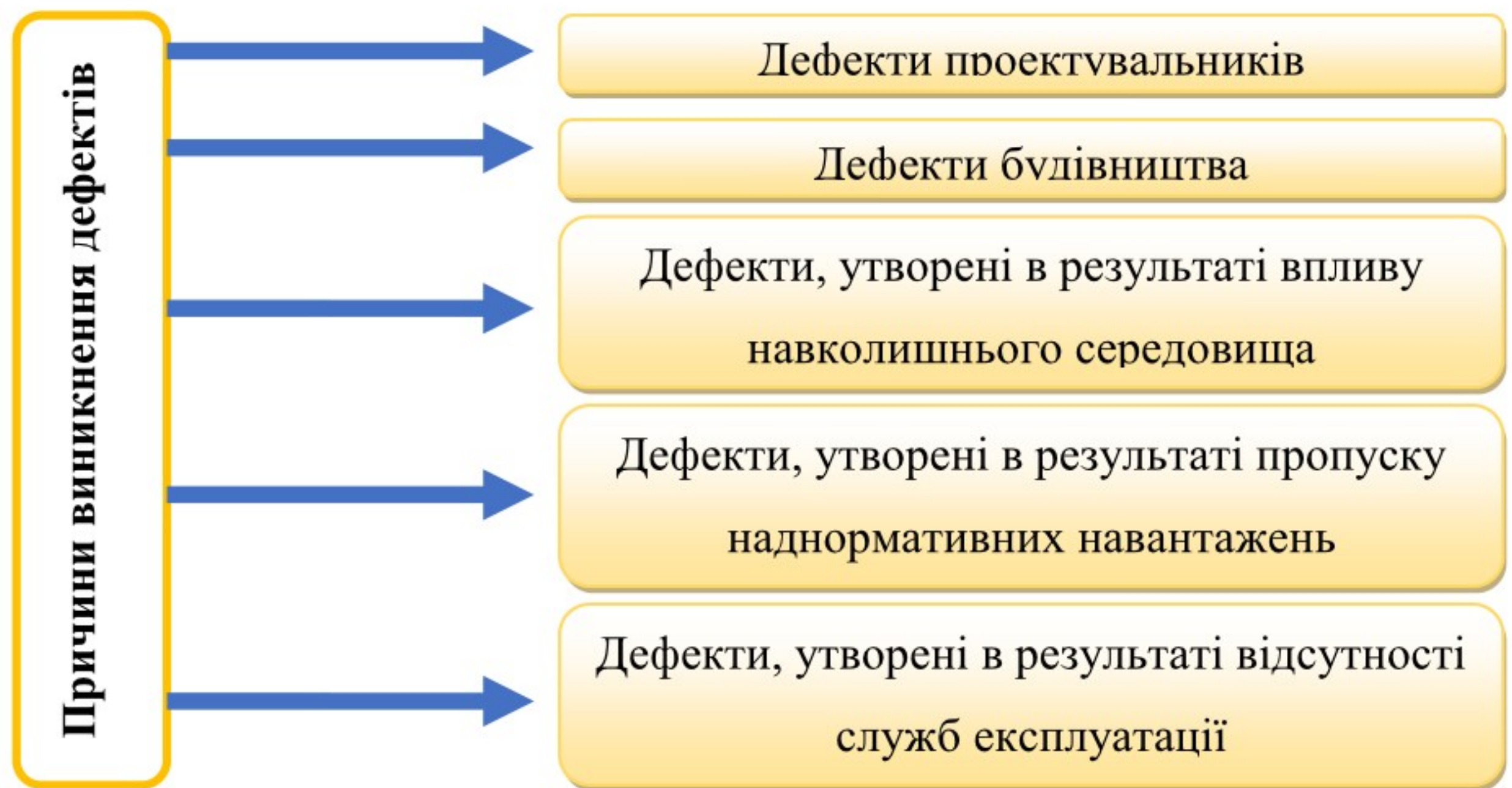
Рисунок 2.3 – Причини виявлення дефектів споруд.
