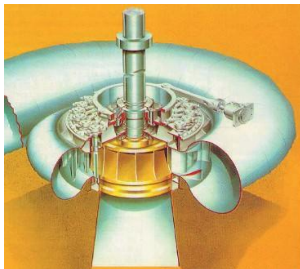
Рисунок 1.7 – Схематичне зображення спіральної камери й турбіни
