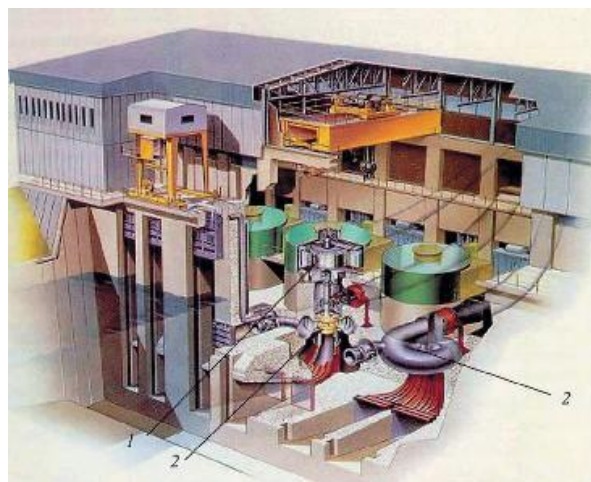
Рисунок 1.7 – Схематичне зображення спіральної камери й турбіни
