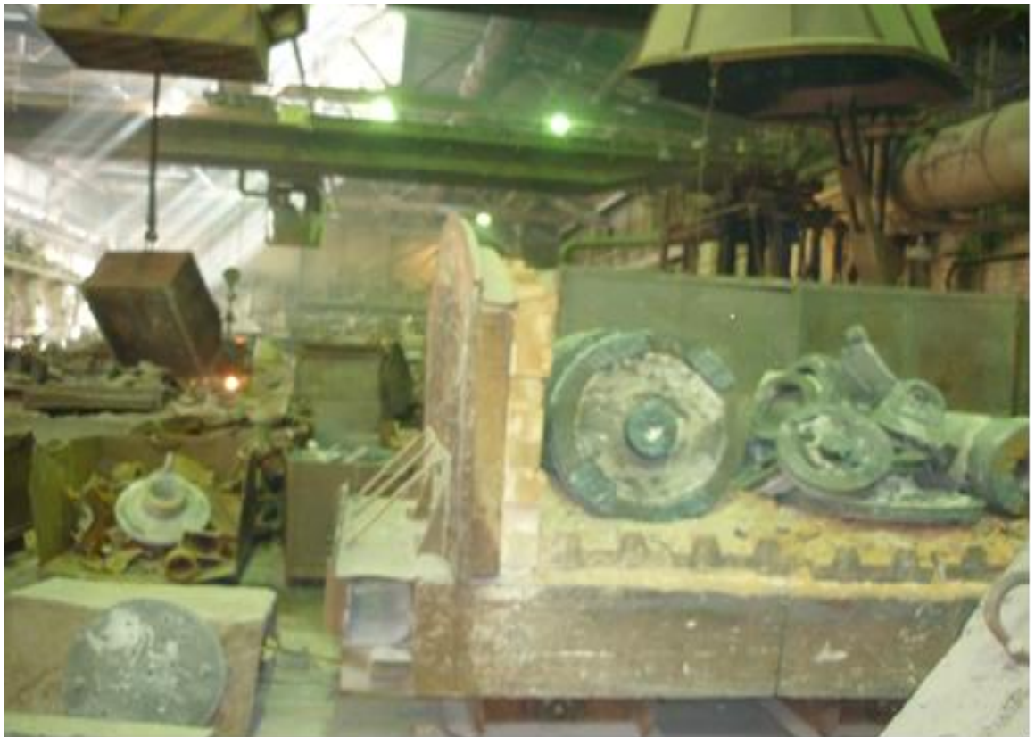
Рисунок 2.2 – Загальний вигляд металевих заготовок на викатному поді, які проходять термообробку у печі відпалу
