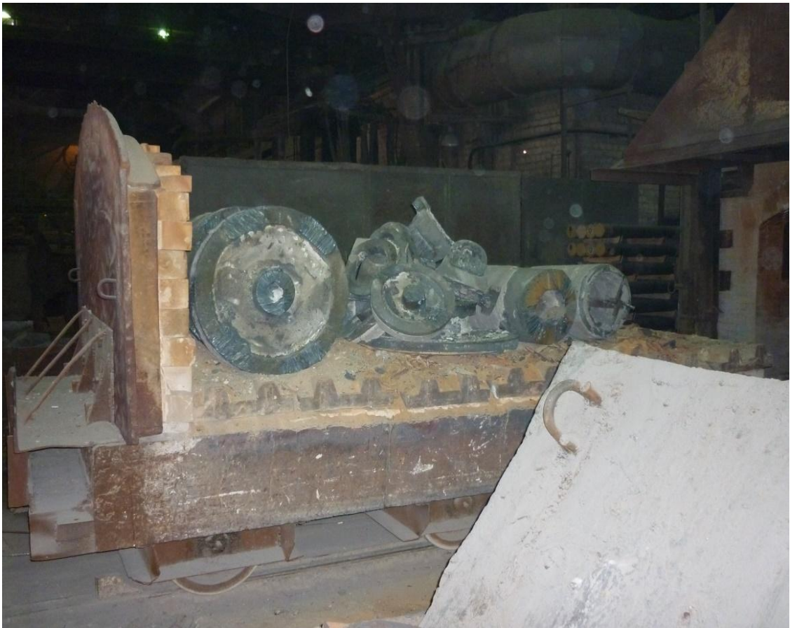
Рисунок 2.9 – Загальний вигляд викатного поду з металевими заготовками
