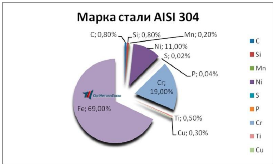
Рисунок 2.3 – Хімічний склад сталі марки AISI 304 [49]
