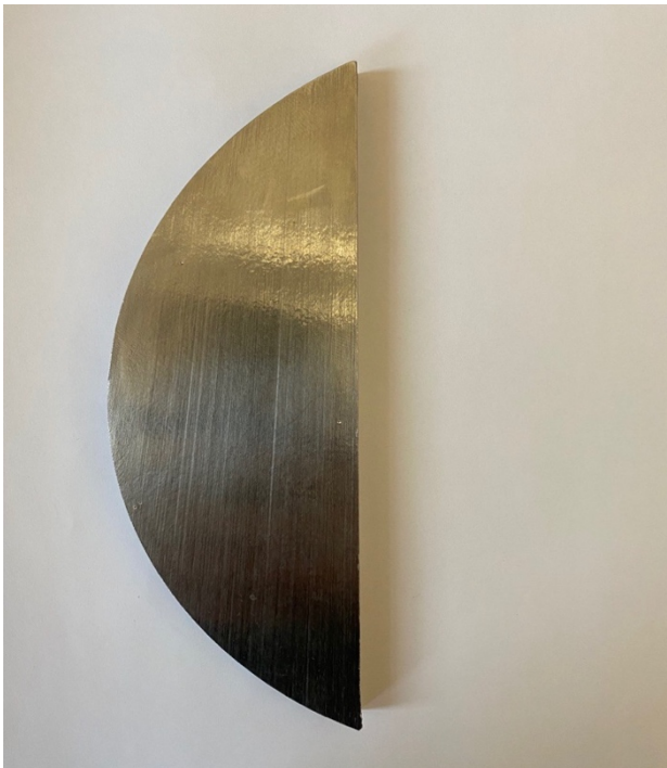
Рисунок 2.1 – Сегмент темплету нижньої частини вилівка промислової плавки Ø310 мм.
