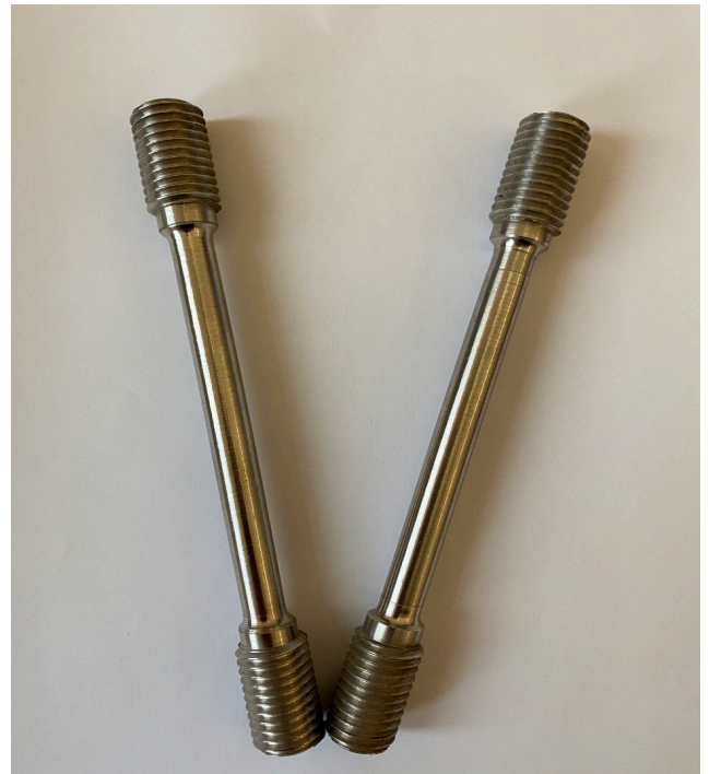
Рисунок 2.2 – Розривні зразки для визначення механічних властивостей сталі 09ХЗНМЗФБч при T=450^{\circ}\text{C}
