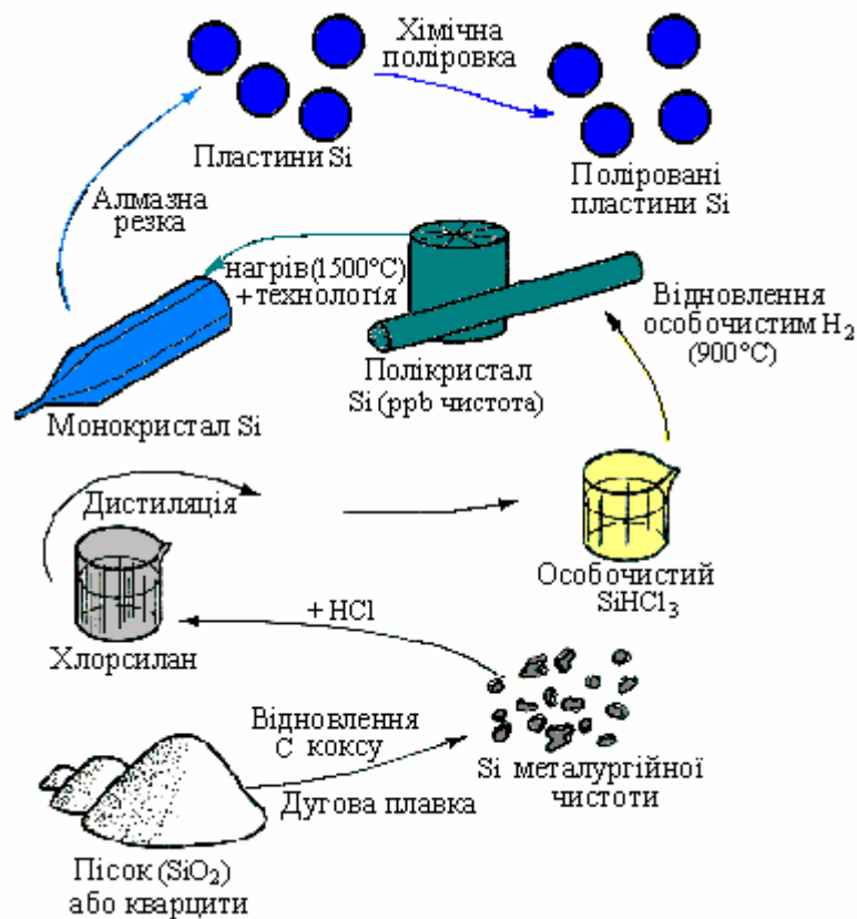
Рисунок 1.3 – Схема отримання напівпровідникового кремнію
