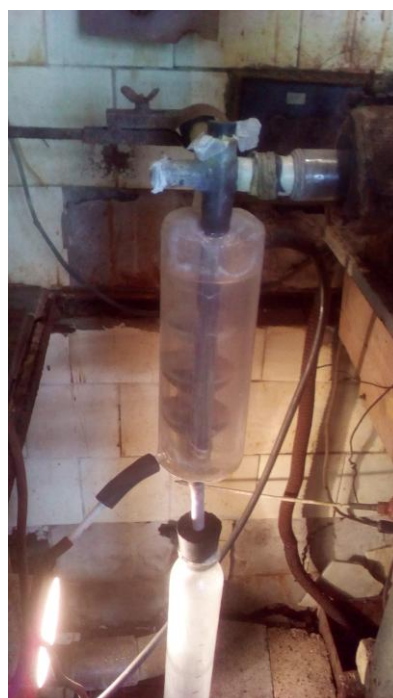
Рисунок 3.2 Хлоратор з хлорпідводом
