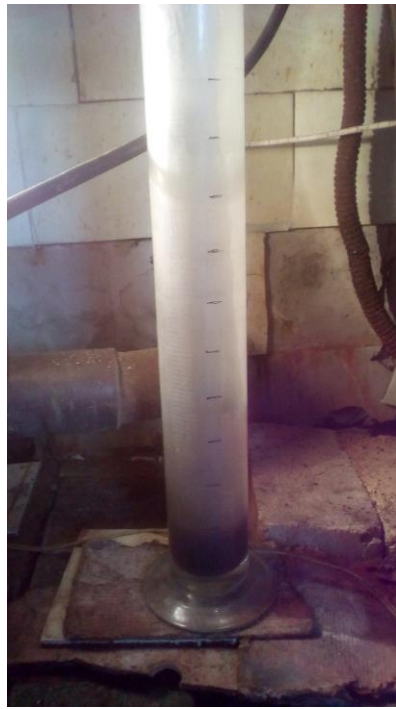
Рисунок 3.4 Приймач тетрахлориду кремнію установки хлорування шихти в розплаві солей
