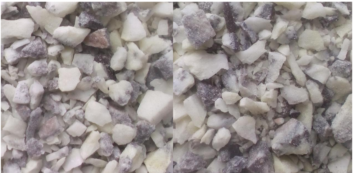
Рисунок 3.10 – Зовнішній вигляд сольового розплаву
