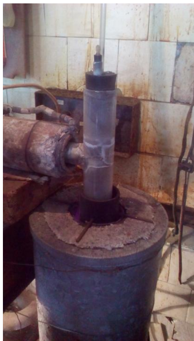
Рисунок 3.2 Хлоратор з хлорпідводом
