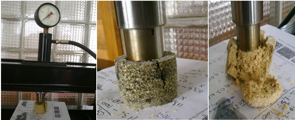
Рисунок 4.3 – Технологічний процес випробувань зразків з відходів деревообробного виробництва на міцність
