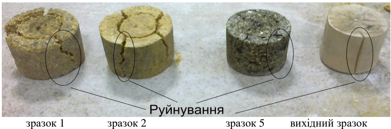
Рисунок 4.4 – Загальний вигляд зруйнованих зразків з відходів деревообробного виробництва [36]
