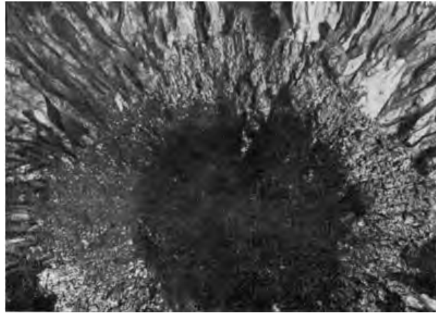
Рисунок 2.1 – Усадкова раковина на зламі
