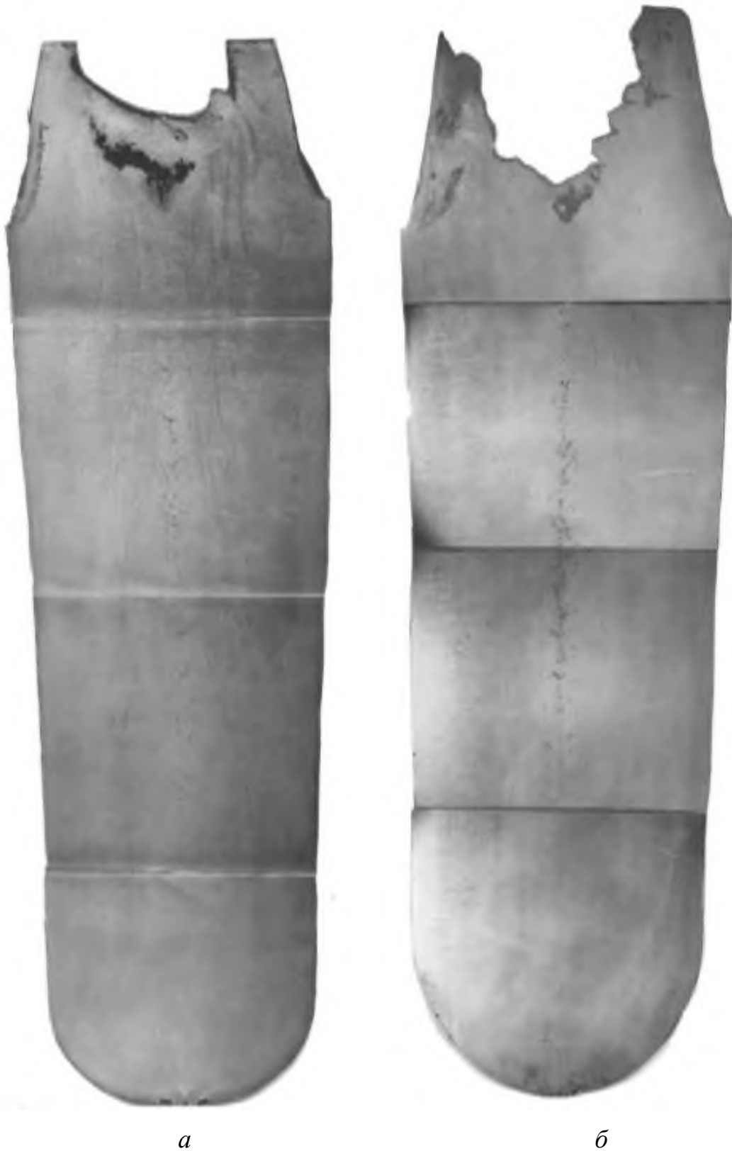
Рисунок 1.9 – Макроструктура зливка масою 4,6 т зі сталі 18ХГТ (дефект: осьова пухкість, V-подібна ліквация, заворот кірки, \Lambda -подібна ліквация) (а) та зливка масою 6,0 т зі сталі 18ХГТ (дефект: \Lambda -подібна ліквация, осьова пухкість, заворот кірки) (б) [16]
