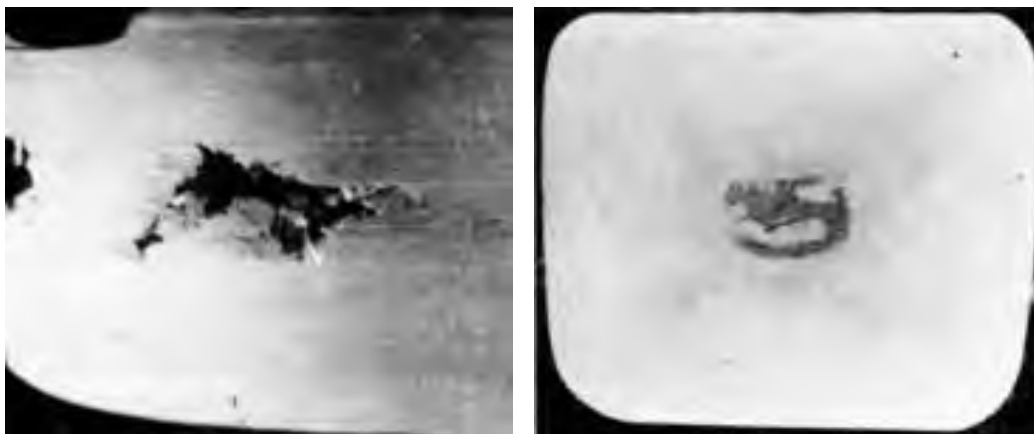
Рисунок 2.2 – Порожнини від усадкової раковини [23]
