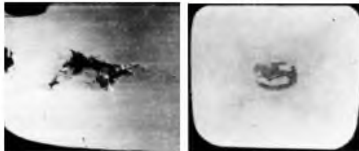
Рисунок – Порожнини від усадкової раковини [6]
