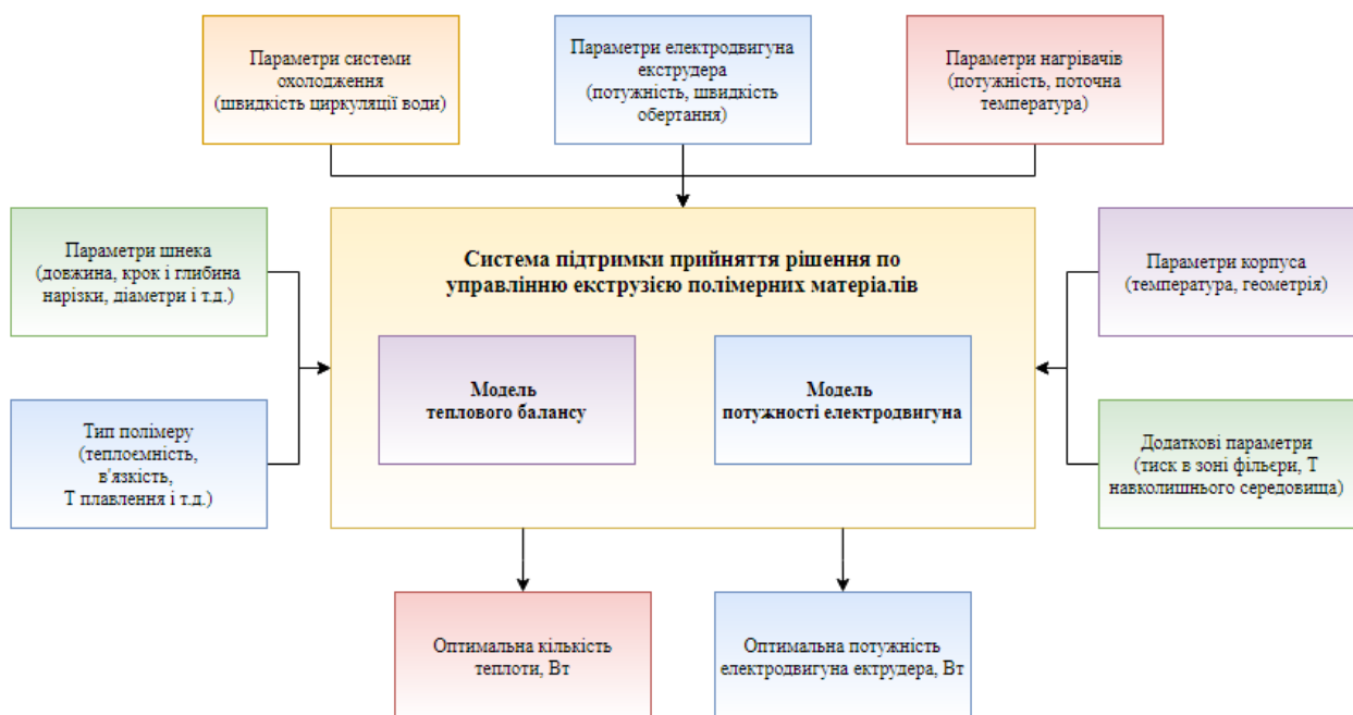
Рисунок 2.8 – Структура математичної моделі системи підтримки прийняття рішення по управлінню процесом екструзії полімерних матеріалів
