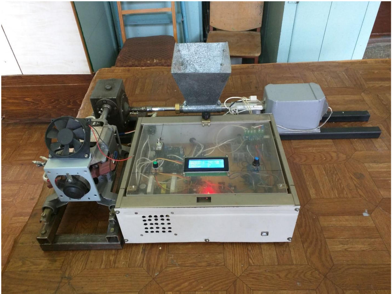
Рисунок 3.2 – Розроблений малогабаритний екструдер
