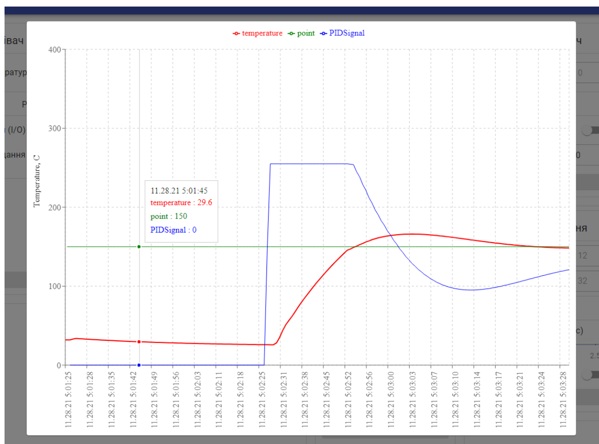
Рисунок 5.18 – Графік зміни температури нагрівача №1
