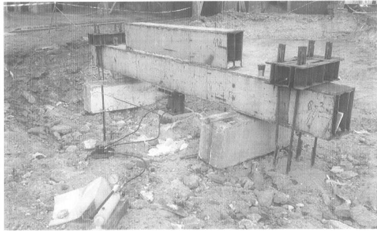
Рисунок 3.6 - Стенд, гідравлічних домкратів під час випробувань палі ДП-2
