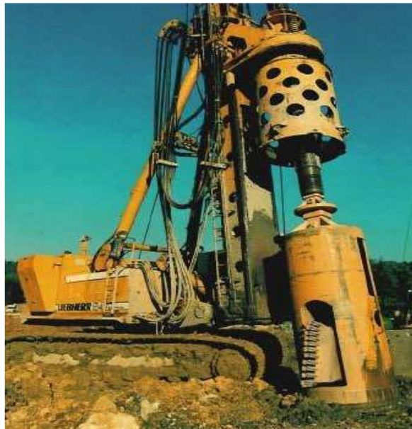
Рисунок 3.1. – Циліндр з висувними лопатами
