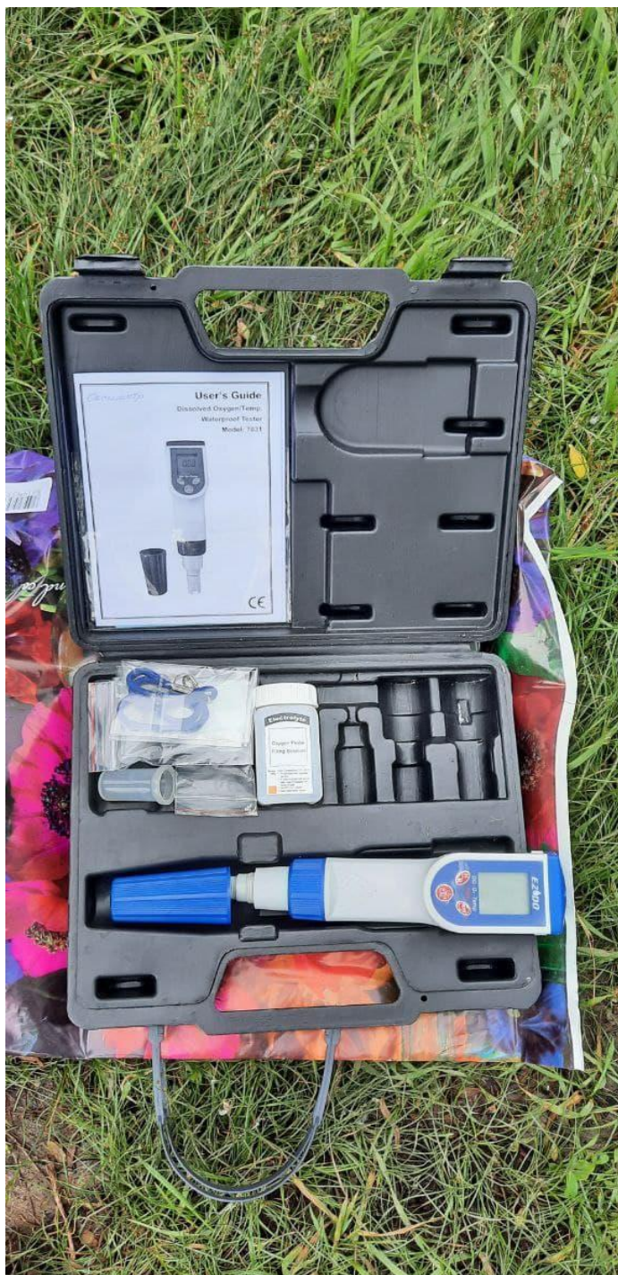
Рисунок Б.1 – Оксиметр – прилад для визначення показників вмісту розчиненого кисню у \text{mgO}_2 / \text{dm}^3 , який було використано під час відбу проб.
