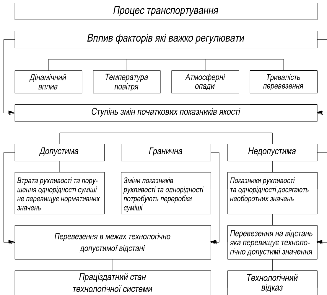
Рисунок 2.8 - Функціональна схема транспортування товарних бетонів.
