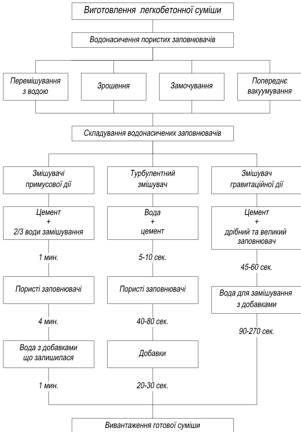
Рисунок 2.7 - Блок-схема приготування легкобетонної суміші.
