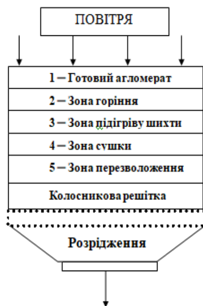
Рисунок 1.2 – Схема процесу спікання
