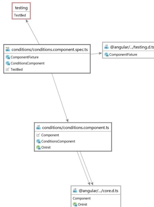
Рис.26 UML-діаграма компоненту Conditions
