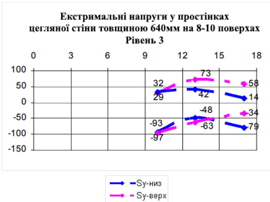
Рисунок 2.8 – Екстримальні напруги (т/м 2 ) для третього рівня будівництва
