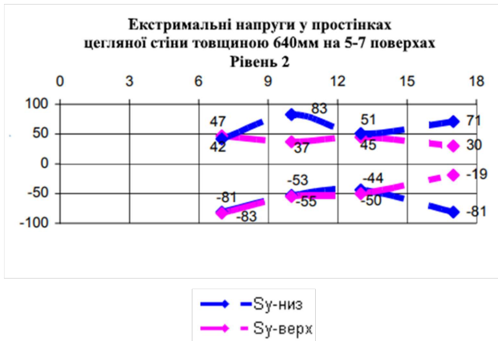
Рисунок 2.6 – Екстримальні напруги ( \text{т/м}^2 ) для другого рівня будівництва
