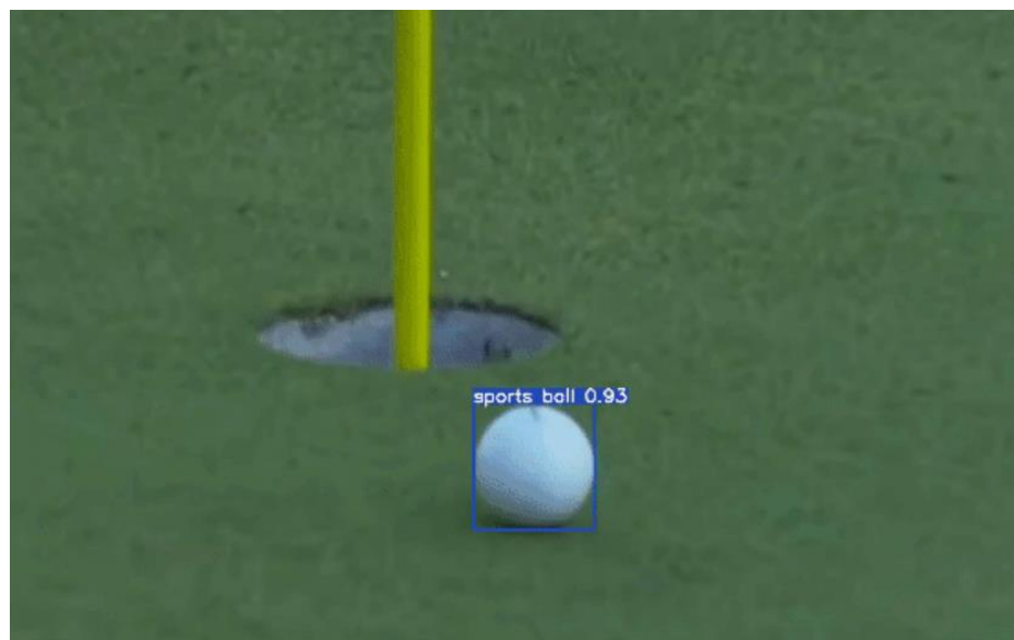
Рис. 50 Розпізнавання м'яча у гольфі за допомогою YOLOv4
