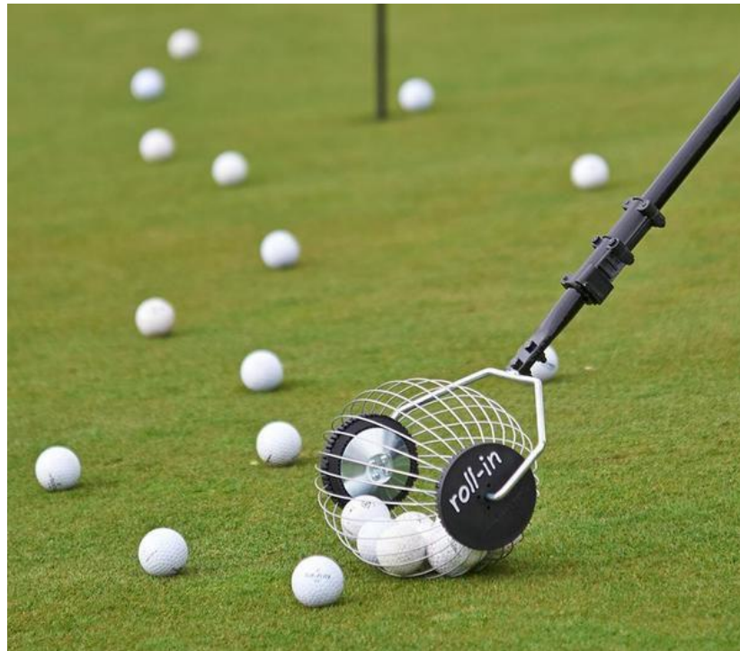
Рис. 4 Полумеханізований пристрій у формі рола-колеса с ручкою
