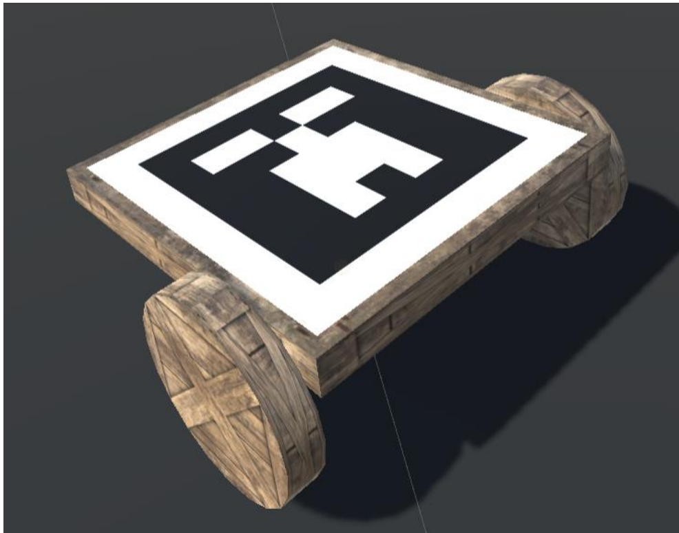
Рис. 55 Aruco-маркер 5x5 з кодом «116» на прототипі робота у симуляції
