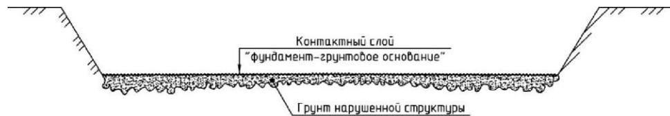
Рисунок 3.1 – Схема розташування зони розструктурених ґрунтів при виконанні робіт «нульового циклу»
