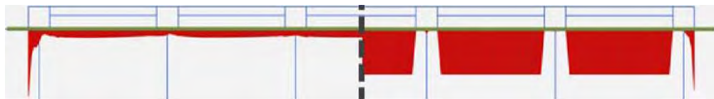
Рисунок 2.4 - Вплив обпресування на характер контактних тисків під подошвою КСПФ на початковому етапі будівництва (ліворуч) та на етапі виконання обпресування (праворуч)
