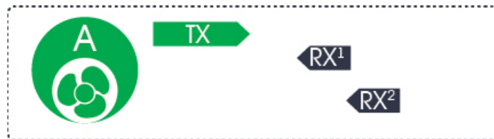
Рисунок 2.4 – Клас А двонаправлені кінцеві пристрої з певним часом очікування низхідного потоку
