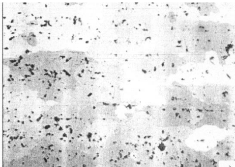
Рисунок 3.25 - Структура сплаву АМц2 після остаточного відпалу відповідно до проведеним досвідам у матриці планування
