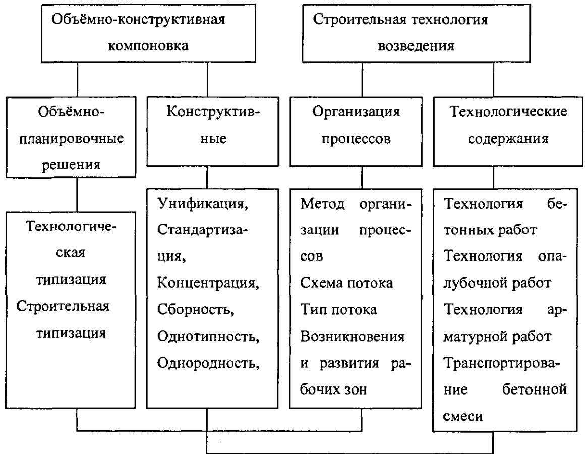
Рисунок 2.1 - Взаємозалежність характеристик технологічності об'ємно-конструктивного компонування з характеристиками будівельної технології зведення висотних цивільних будівель із монолітного залізобетону.
