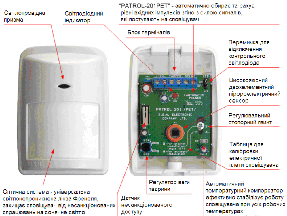
Рисунок 2.6 - Конструкція інфрачервоного датчика
