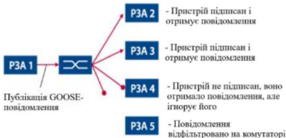
Рисунок 1.6 - Схема передачі GOOSE-повідомлень
