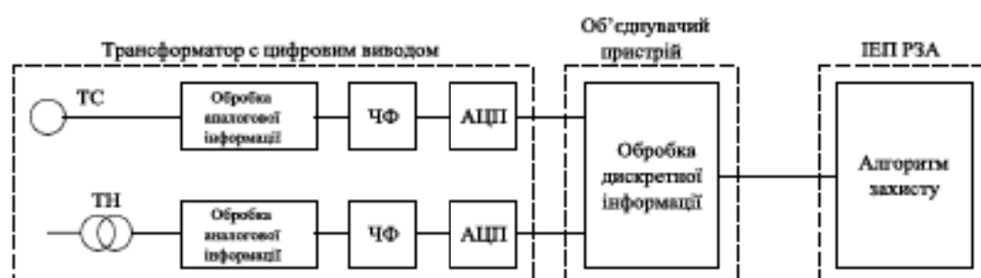
Рисунок 2.7 – Цифрова підстанція третього порядку
