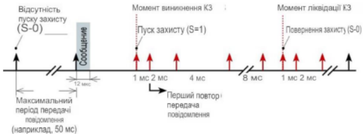
Рисунок 1.5 - Принцип передачі GOOSE – повідомлень
