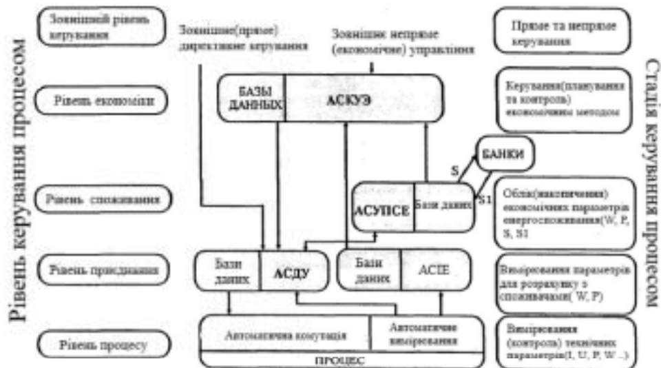
Рисунок 2.8 – Схема взаємодії при керуванні енергоспоживанням
