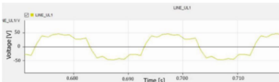
Рисунок 3.15 – Розкладена форма сигналу напруги за допомогою гармонічного спотворення трьох гармонік
