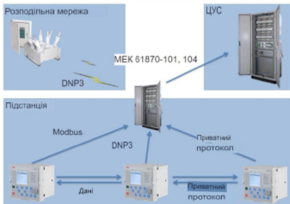
Рисунок 1.1 - Принципова схема організації передачі даних
