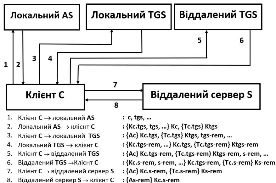
Рисунок 1.6 – Взаємна перевірка клієнтом «С» та віддаленим сервером «S»-rem автентичності один одного (варіант 4)
