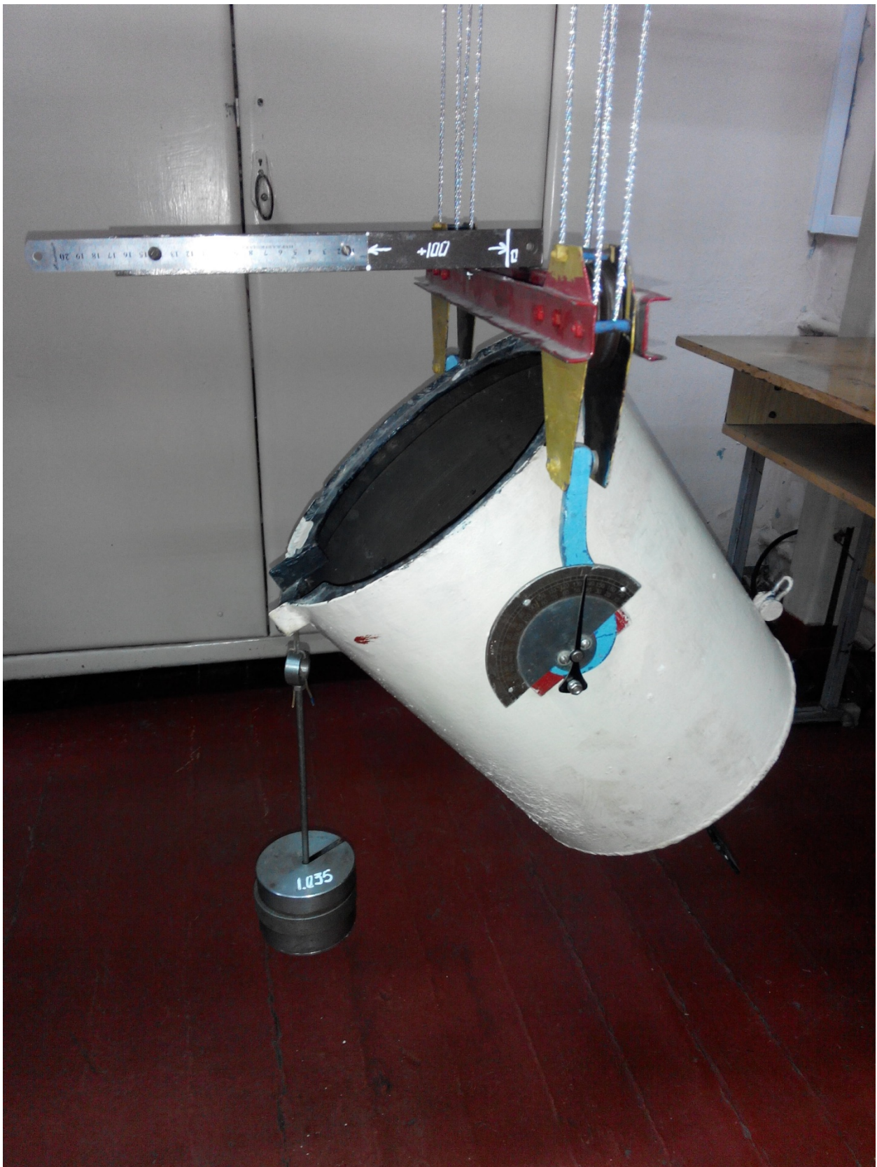
Рисунок 2.2 - Фотографія моделі ковша із траверсою.
