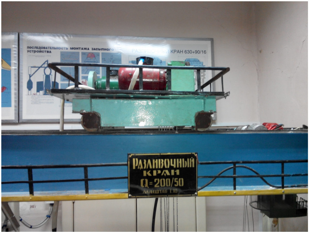
Рисунок 2.1 - Фотографії моделі розливочного крану.
