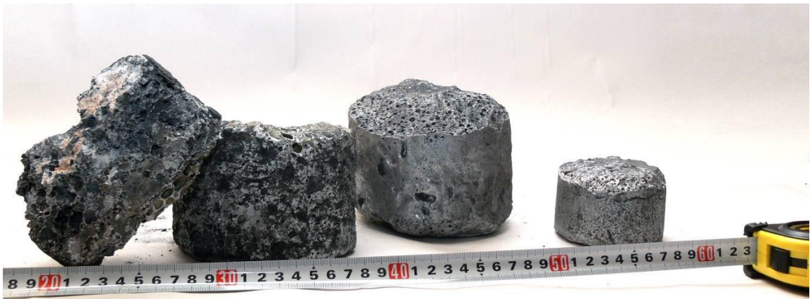
Рисунок 2.2 – Зовнішній вигляд синтезованих злитків Fe-Al-Co-Mn-Cu сплаву (масою 4 кг, 3,2 кг, 2,4 кг, 0,7 кг) після відділення оксидної фази
