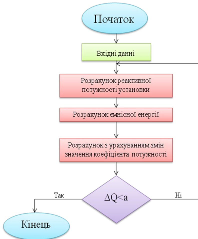
Рисунок 2.22 – Блок – схема алгоритму розрахунку конденсаторної установки необхідної для компенсації
