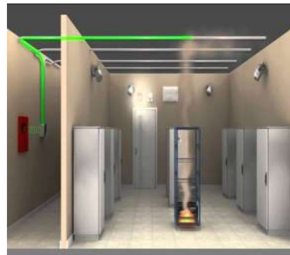
Установка аерозольного пожежогасіння
