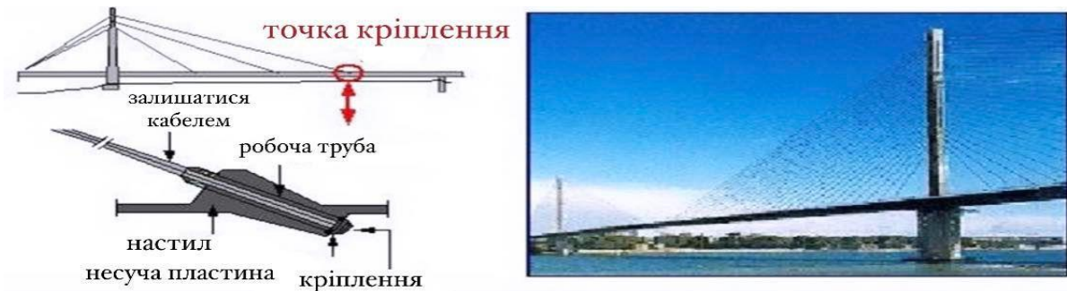
Рисунок 3.28 – Залишайтеся кабельними кріпленнями на бетонній колоді
