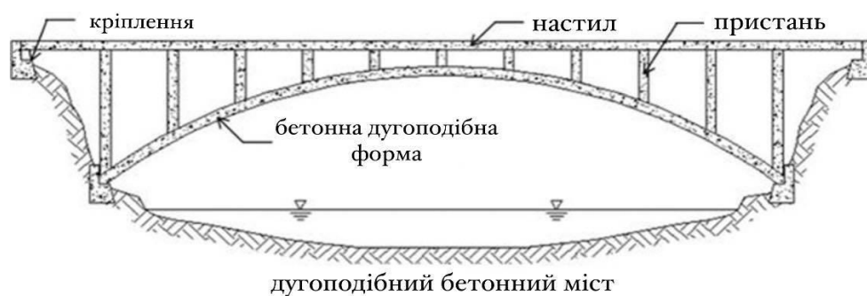
Рисунок 3.6 – Бетонні мости середньої довжини прольоту
