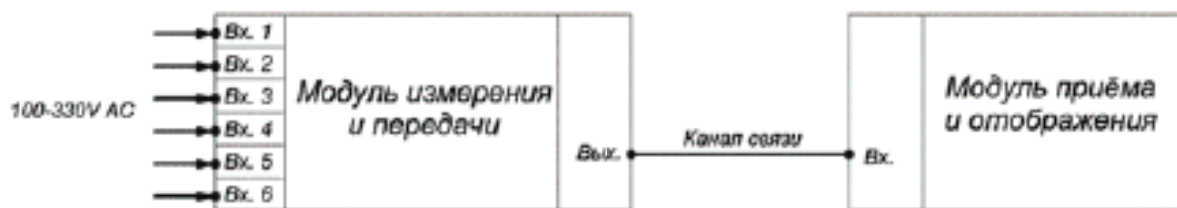
Рисунок 1.10 – Структурна схема вольтметра
